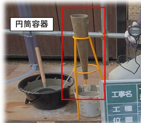
流動性試験状況
